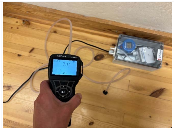
Kuva 5. Hetkellinen paine-ero liikuntasalista ja lattian eristetilan välillä.
