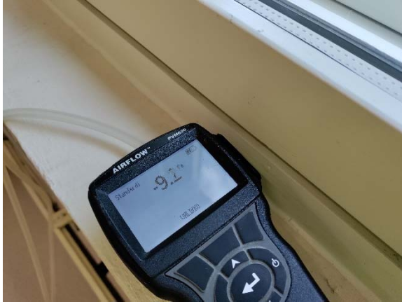
Kuva 23. Hetkellinen paine-ero mittauksen aikana.
