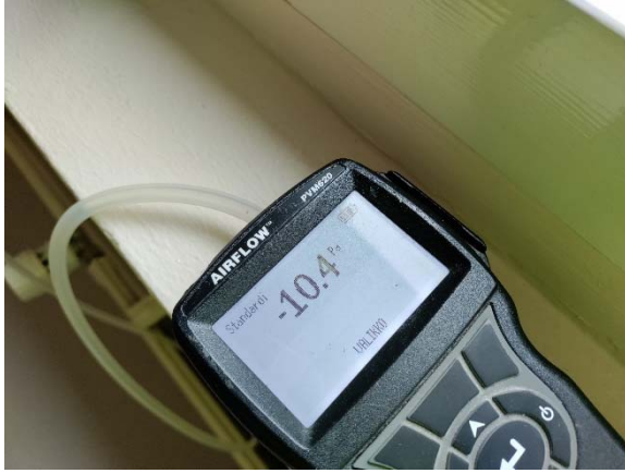
Kuva 31. Hetkellinen paine-ero mittauksen aikana.
