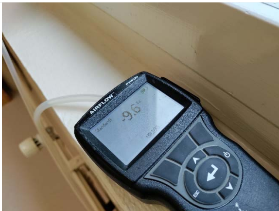
Kuva 25. Hetkellinen paine-ero mittauksen aikana.
