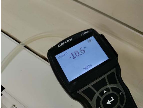
Kuva 1. Hetkellinen paine-ero mittauksen aikana.
