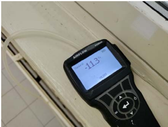
Kuva 3. Hetkellinen paine-ero mittauksen aikana.
