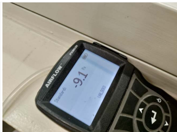
Kuva 13. Hetkellinen paine-ero mittauksen aikana.
