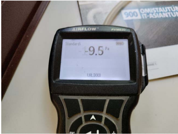
Kuva 35. Hetkellinen paine-ero mittauksen aikana.
