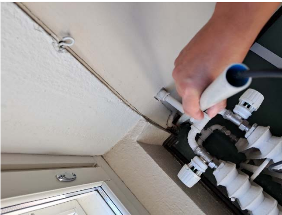
Kuva 81. Ilmavuotopaikka musiikkiluokan 203 patteriputken läpiviennistä.
