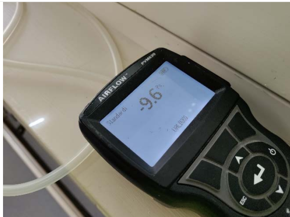
Kuva 49. Hetkellinen paine-ero mittauksen aikana.
