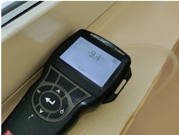
Kuva 37. Hetkellinen paine-ero mittauksen aikana.
