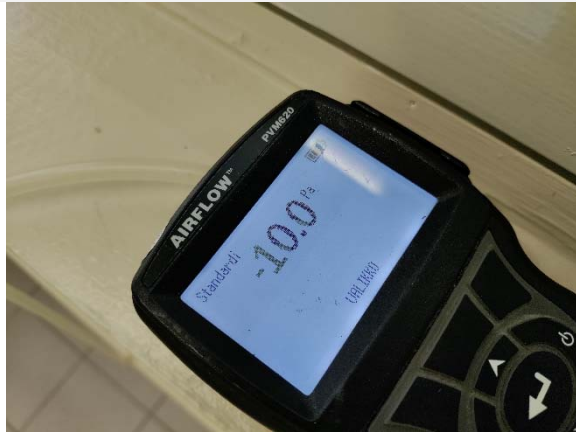
Kuva 19. Hetkellinen paine-ero mittauksen aikana.
